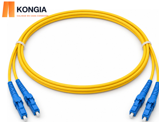
PATCH CORD DE FIBRA ÓPTICA 1 m · OS2 · Duplex LC/UPC ↔ LC/UPC LSZH · 2.0 mm · 2 fibras KG-FO-PC-LCU-LCU-OS2-DX-01M
