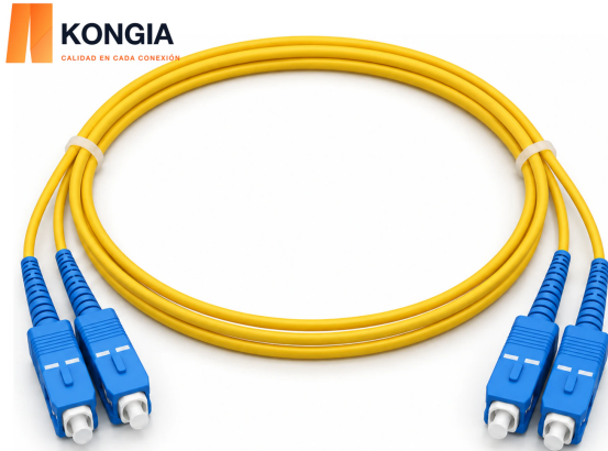
PATCH CORD DE FIBRA ÓPTICA 1 m · OS2 · Duplex SC/UPC ↔ SC/UPC LSZH · 2.0 mm · 2 fibras KG-FO-PC-SCU-SCU-OS2-DX-01M
