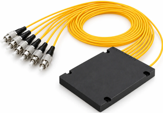
DIVISOR ÓPTICO PLC EN CAJA 1x4 FC/UPC · 1260-1650 nm
